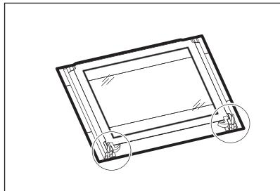
5. Oldja ki a reteszelőrendszeret a belső üveglap kiszereléséhez.
