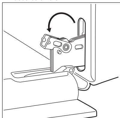
3. Închideți pe jumătate ușa cuptorului până la prima poziție de deschidere. După aceea împingeți și scoateți ușa din locaș.
